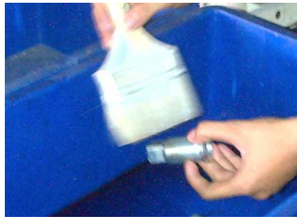
PELAPISAN PIN WHEEL DENGAN OLI
